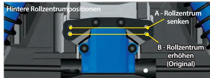
**Hinweis:** Wenn sie die vorderen Verbindungen in die untere Position verschieben (anders als die Original-einstellungen), muss das Kugelgelenk in der Lenkung gekippt werden. Die äußeren Kugelgelenke befinden sich in der Werkseinstellung in der unteren Position (A). Wenn das Rollzentrum verschoben wird, muss das Offset gekippt werden (B).
