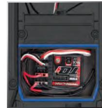
**Hinweis:** Für beste Performance empfehlen wir, diesen Empfänger mit derselben Ausrichtung zu installieren, mit der auch der Original-Empfänger installiert war wie gezeigt.
