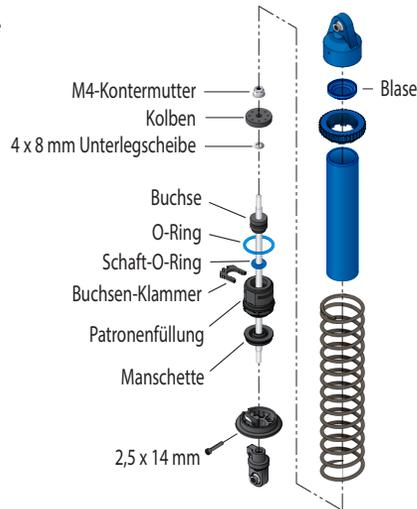
**Hinweis:** Die neue Kartusche muss am Stoßdämpferschaft befestigt werden. VERSUCHEN SIE NICHT, die Kartusche separat zu montieren und auf den Schaft zu schieben. Dies kann eine Beschädigung des O-Rings am Schaft sowie ein Leck zur Folge haben.
